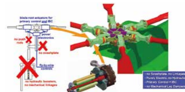
图5 独立桨叶控制原理
