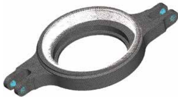
图10 旋翼动盘有限元模型
