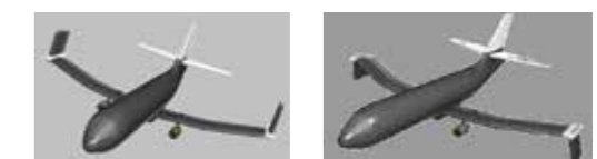
向上折叠 向下折叠 图3 展向自适应机翼概念图(NASA)
