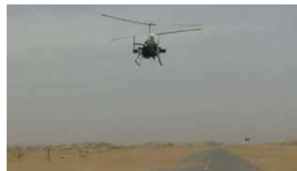
TD5消防救援无人直升机在沙漠开展沙尘环境适应性测试
