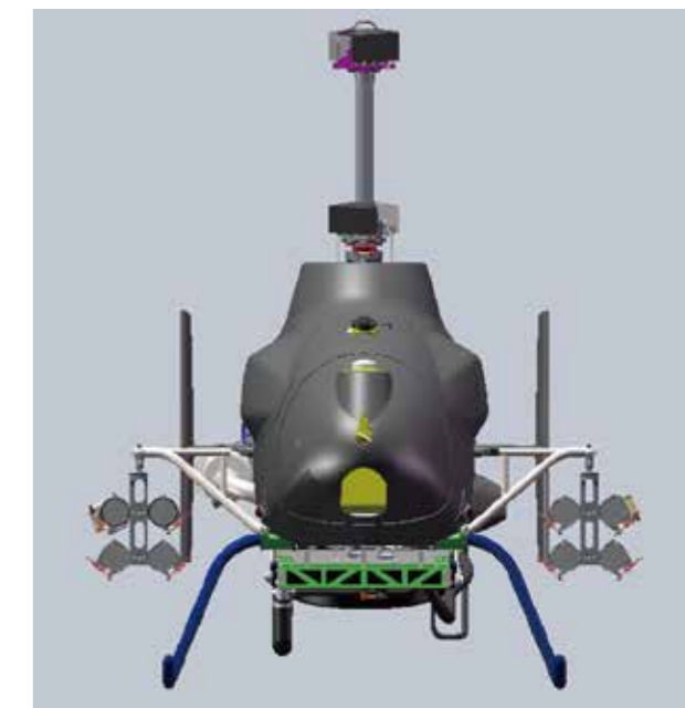
TD5消防救援无人直升机带8枚10kg灭火弹前视图
