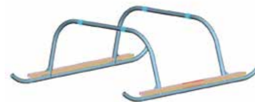
图 2 起落架静力计算有限元模型
