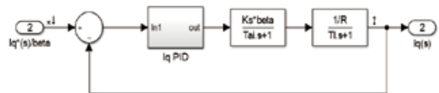
图4 电流闭环动态模型结构图简化
